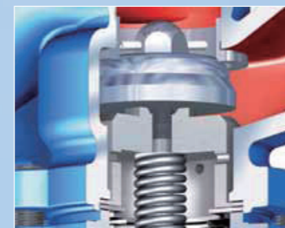
가열시스템에서 센서측 온도가 올라가면 밸브가 닫힙니다. (Thermal closing valve)
